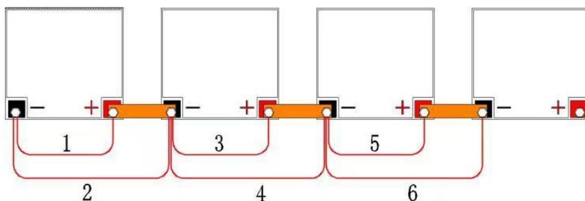
成组测试中，当选择“连接条测试”模式时，请按照上图 1、2、3、4、5、6 的测试夹连接顺序进行测试，仪表会自动计算出每一节电池的内阻值与连接条阻值。测试完电池内阻后，仪表会暂停测试，并提示“切换测试夹”，连接条测试完成以后，仪表会提示“测试已完成”
