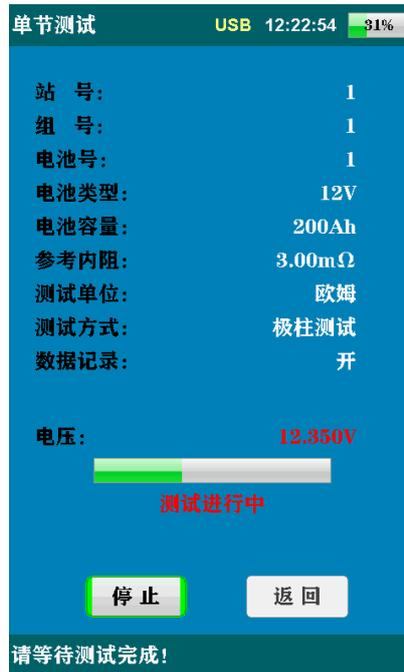
单节测试过程中请等待测试完成，也可以手动按下【停止】按钮，中断测量操作。
