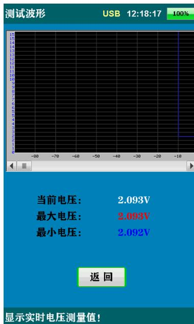
实时显示测量的电压值，以及所测量电压的最大值和最小值。
