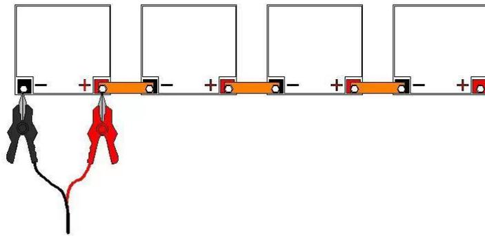
本仪表具有准确测量蓄电池内阻的功能，与电池的接方式如上图：
