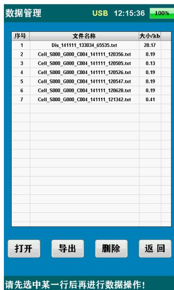
数据管理界面，可以对测试记录数据进行打开、导出至 U 盘，以及删除操作，在进行以上操作前需要先选中表格内的某一行数据，否则会提示操作错误。为防止数据误删，数据
