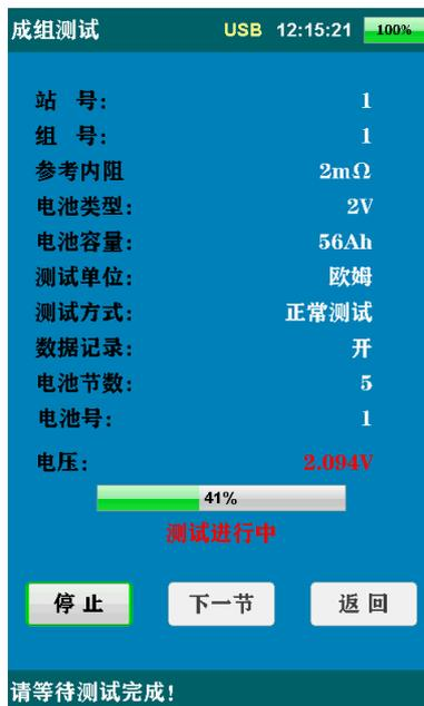
成组电池测量界面如下，其测量操作方法与单节电池测量相似，只是增加了电池节数，在一组电池测试完之后，可以直接点击【下一节】按钮，电池号会自动增加，并进行测试。也可以点击【重测】按钮重新对该节号的电池进行一次测试。
