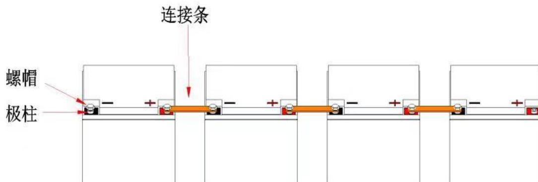
测试中，请勿将测试夹，夹在螺丝帽上，这样会影响测试精度，可夹在极柱上或者连接条上。
