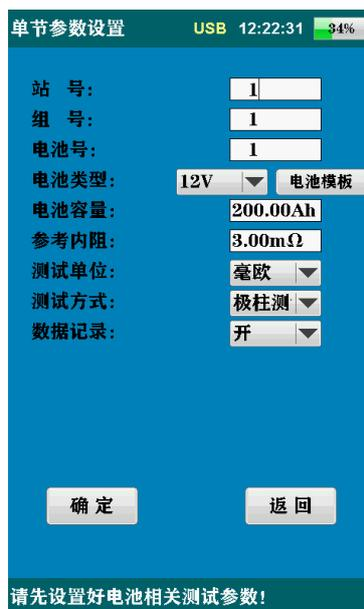
进入单节测试后，分别选择好电池电压类型、电池型号、测试参数、站点编号后即可进行测量。
